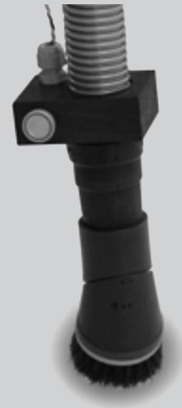
Sicherheitssauger Typ M (Schimmelsporen) im Schallschutzgehäuse.
